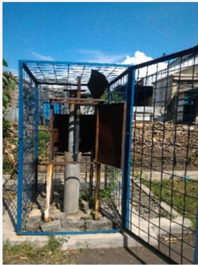
Rekonstruksi Rekaman Jejak Penurunan Tanah Pada Alat Pemantauan Wilayah Tongkol - Jakarta Utara
